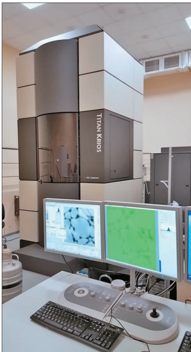
Рис.1. Просвечивающий микроскоп Titan Krios (FEI, США).
